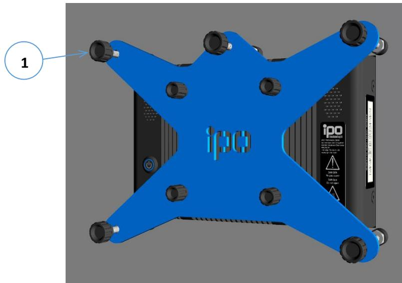
**ATTENTION, NE PAS UTILISER D'OUTIL POUR LE SERRAGE des patins !!!** Un serrage manuel est suffisant et correspond à un couple de 0,5 à 0,6 N.m.
